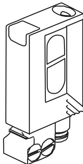
Schrauben Sie die Halterung mit den beigelegten Schrauben fest und schieben Sie das Gerät in die Führung des Halters bis die Haltefeder einrastet.
