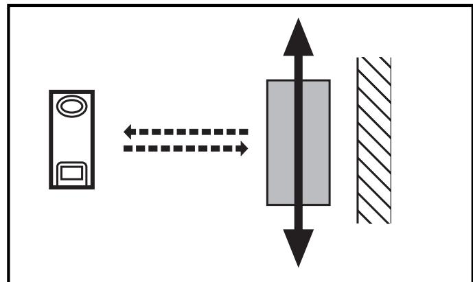
En cas d'applications difficiles (faible distance entre l'objet et l'arrière-plan) nous recommandons les positions de montage suivantes:
