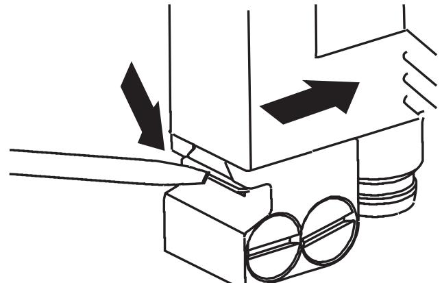
Zum Lösen des Gerätes drücken Sie die Haltefeder mit Hilfe eines Schraubendrehers nach unten und ziehen das Gerät von der Halterung.
