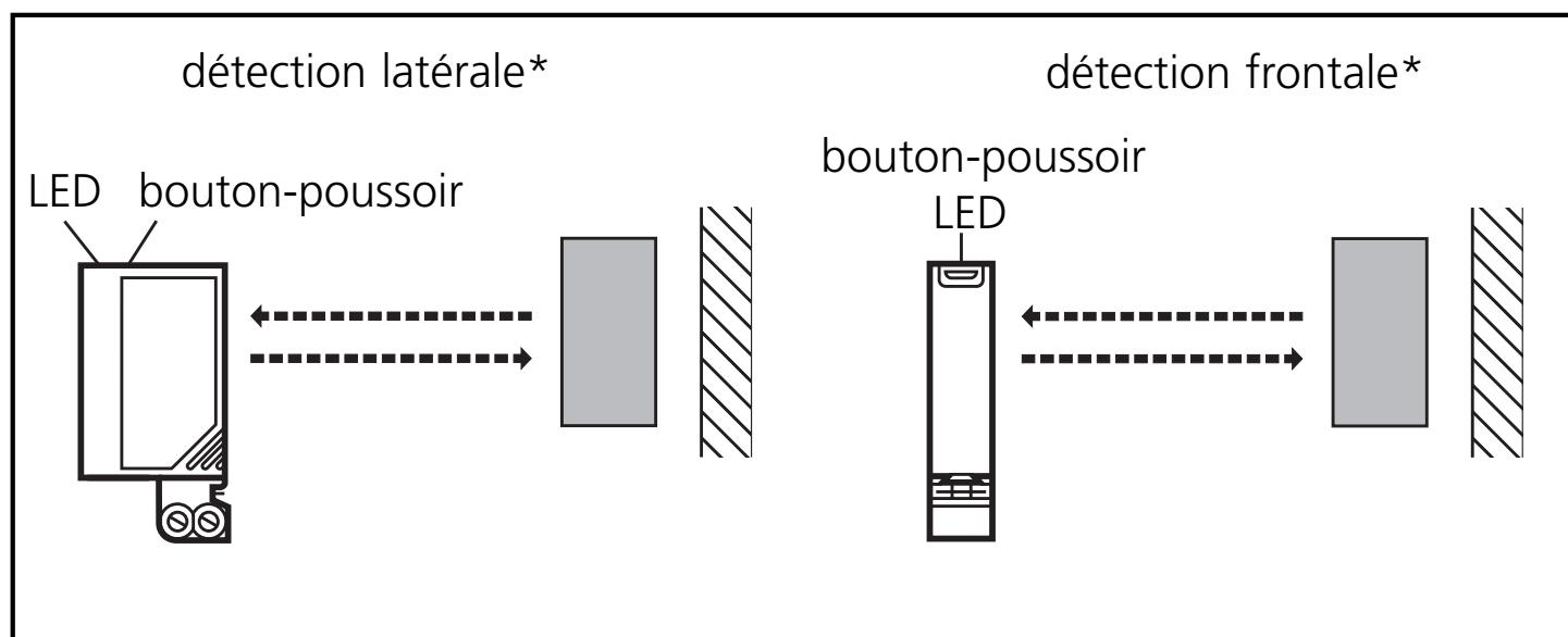
\* Ci-dessous, le montage et le réglage sont décrits à l'aide d'une cellule avec détection frontale. Les fonctions des cellules avec détection latérale sont identiques.
