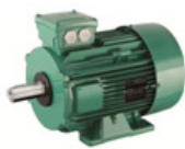
LSES IE2 – IE3 Aluminium IP55 Bouwgrootte 80 tot 315 2,4 & 6 polen 0,75 tot 200 kW
