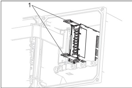
Fig. 7: Removing module
